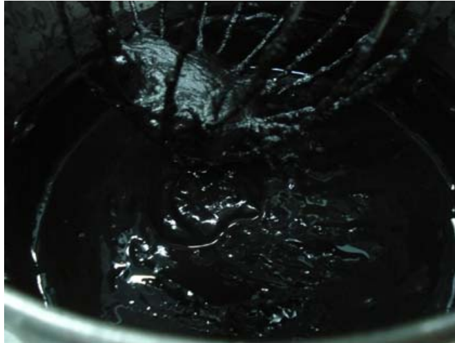
Figura 10. Aspetto della sospensione di carbone in acqua durante la fase di miscelazione
