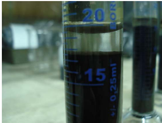
Figura 14. Determinazione dei parametri di stabilità della miscela CW: formazione del volume di acqua chiara
