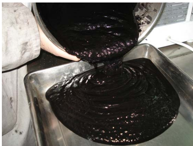
Figura 19. Consistenza tipica della miscela CW (Sulcis 70/30 con proporzione di carbone del 60%).
