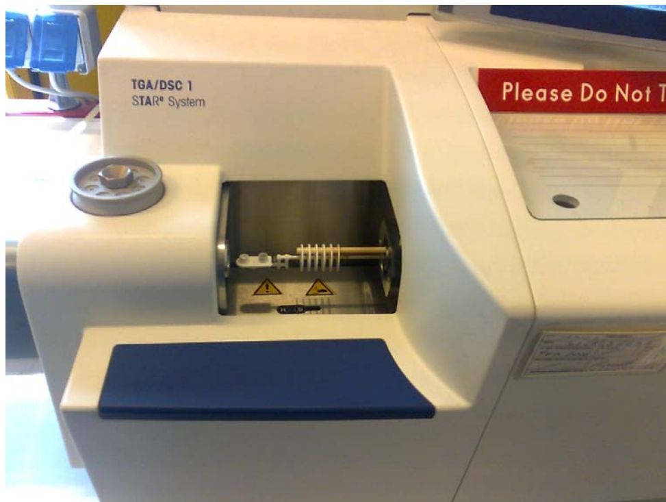
Figura 7b: Vista di dettaglio della fornace con il doppio crogiolo
