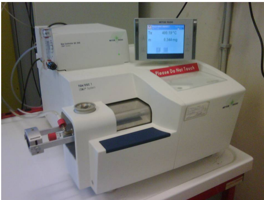
Figura 4: bilancia termogravimetrica modello Mettler-Toledo TGA-DSC1
