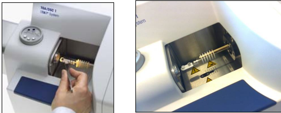
Figura 6: alloggiamento del campione sulla bilancia
