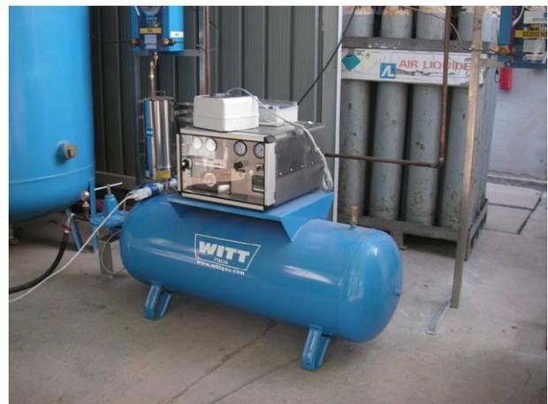
Fig. 16 – Dettaglio miscelatore ossigeno e CO<sub>2</sub>
