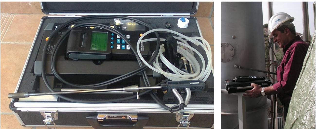
Fig. 19 – Sistema di analisi basato su celle elettrochimiche
