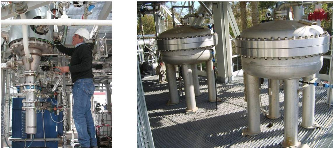
Fig. 14– Impianto Laboratorio: dettaglio del gassificatore dei due reattori di cattura della CO<sub>2</sub>.
