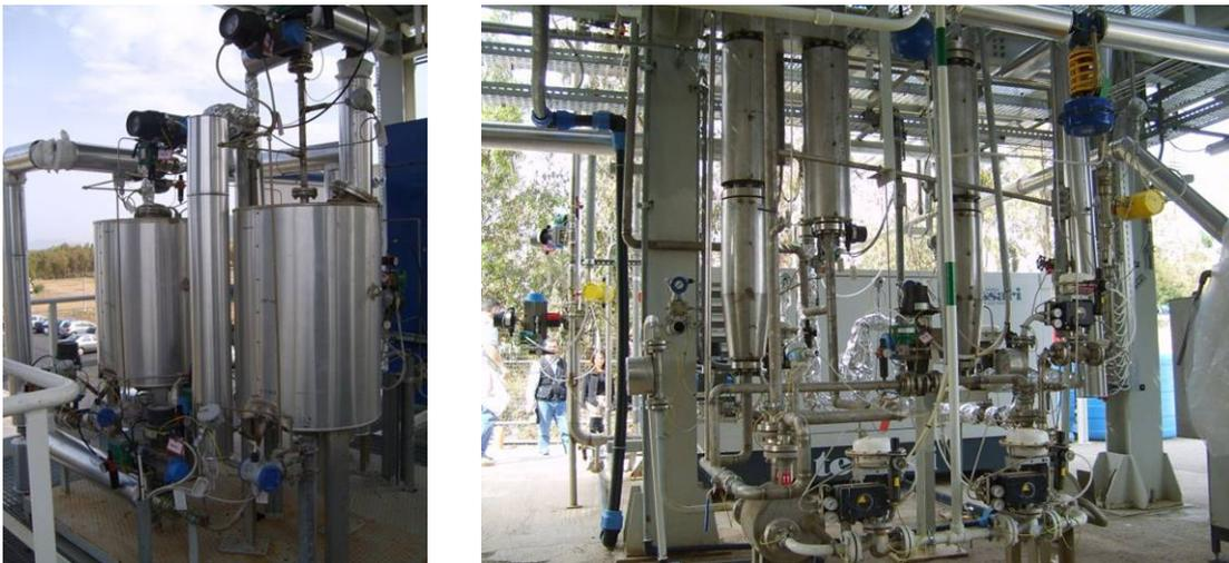
Fig. 15– Impianto Laboratorio: dettaglio delle sezioni di desolforazione a caldo e CO shift
