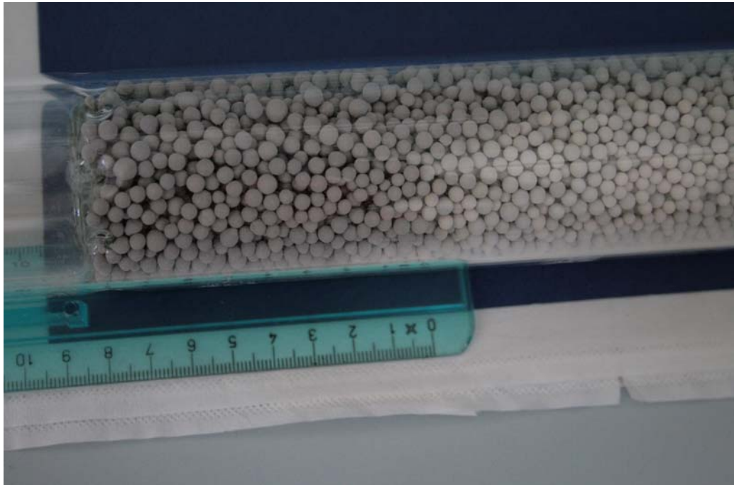
Fig. 3.2: Acquisizione dei dati sperimentali: misura del letto esausto al termine di una fase di desolfurazione della durata complessiva di 11 ore. .
