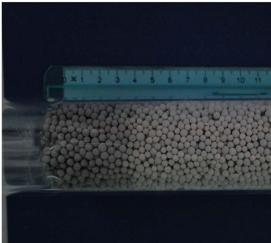
Fig. 3.1: Acquisizione dei dati sperimentali: misura del letto esausto al termine di una fase di desolfurazione della durata di 6 ore. Dall'immagine è anche osservabile la variazione cromatica subita dal solido in seguito alla captazione di zolfo dal gas e dovuta dunque alla formazione del ZnS. La zona esausta è nettamente separata dalla zona non reagita da una ipotetica superficie di sezione retta, la qual cosa mostra un comportamento verosimilmente comparabile ad un flusso a pistone ideale.
