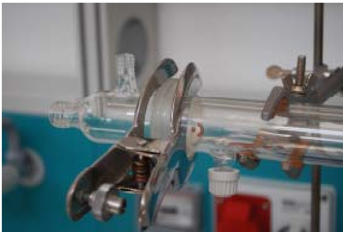
Fig.1.13: Condotto di output gas (particolare). Sono identificabili il bocchello per l'inserimento della sonda di controllo (in basso) ed il bocchello per il prelievo (in alto).
