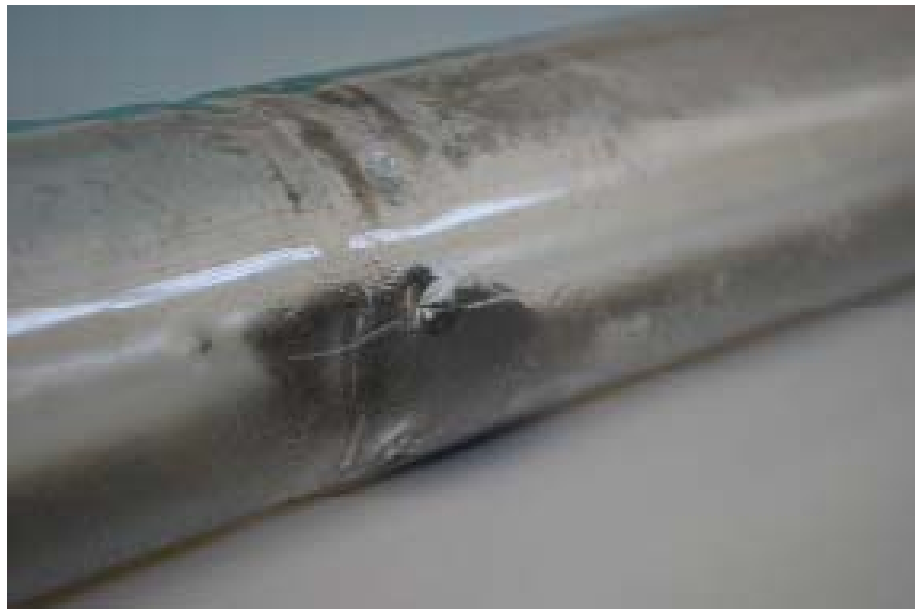
Fig. 2.9: Particolare del reattore al termine della prova in bianco: si nota la presenza di una cricca.
