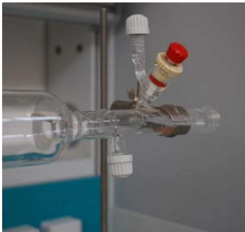
Fig.1.12: Condotto di adduzione gas (particolare). Sono identificabili il bocchello per l'inserimento della sonda di controllo ed il bocchello predisposto per l'alimentazione ausiliaria, dotato di rubinetto
