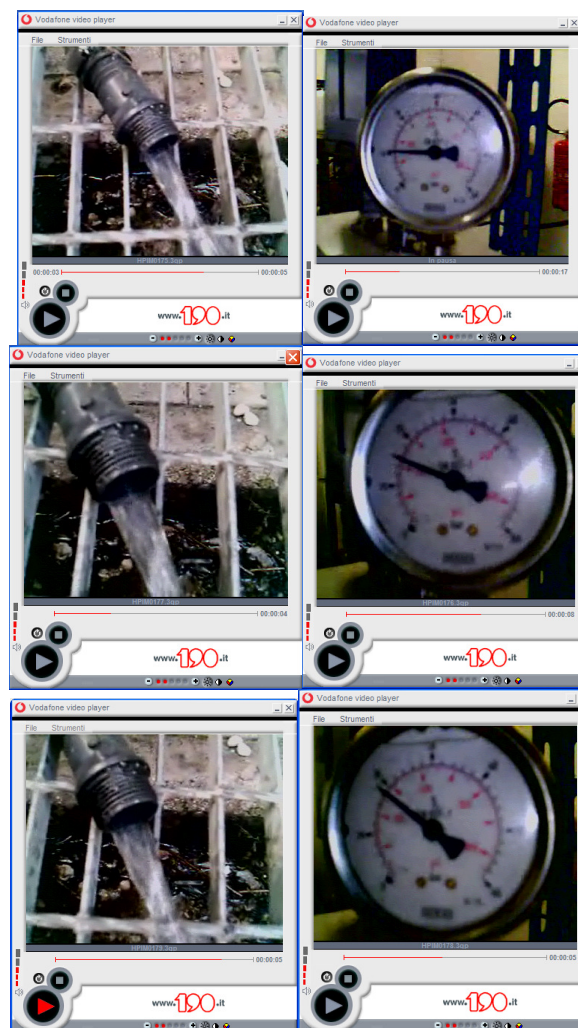
Fig. 10: Test in pressione: 10,15 e 20 bar
