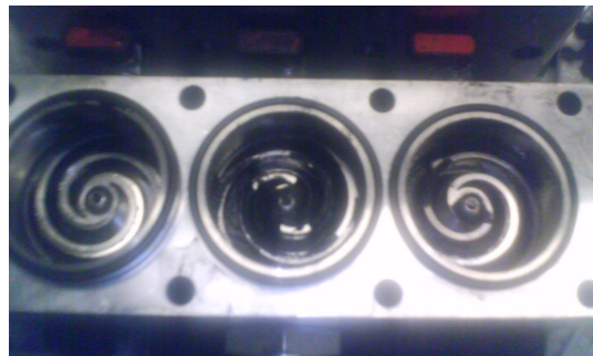
Fig. 7: Valvole con molla piana elicoidale
