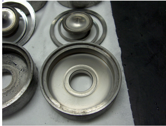
Figura 8 Vista dello stato delle valvole dopo un esercizio 5 giorni (6 ore/gg)
