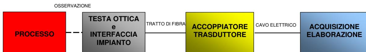
Figura 1 - Schema a blocchi del sistema ODC
