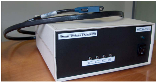
Figura 2 Box di interfaccia per la trasduzione ottica-elettrica
