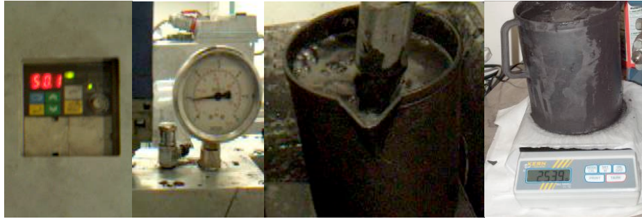
Figura 6 Nelle figure sono riportate i fotogrammi delle quattro fasi della misura: freq. inverter, press. di esercizio, spillamento e pesatura slurry.
