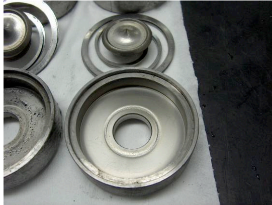
Figura 8 Vista dello stato delle valvole dopo un esercizio 5 giorni (6 ore gg)
