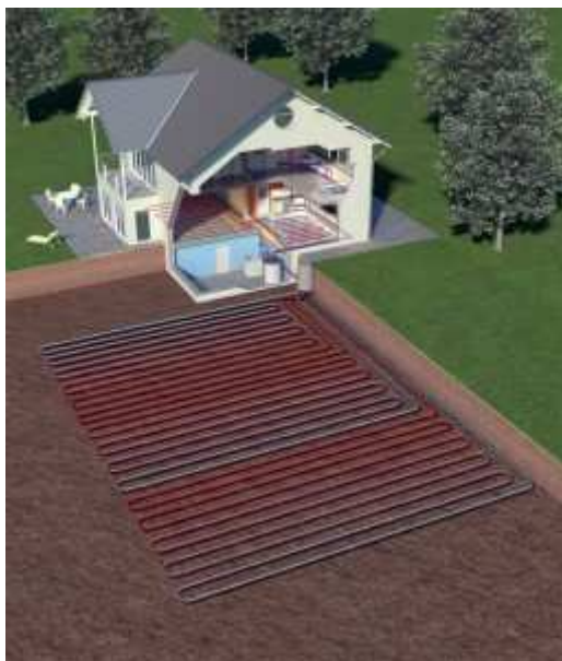
FIGURA 19 SISTEMI GEOTERMICI ORIZZONTALI [WWW.CASAINNOVATIVA.COM]
