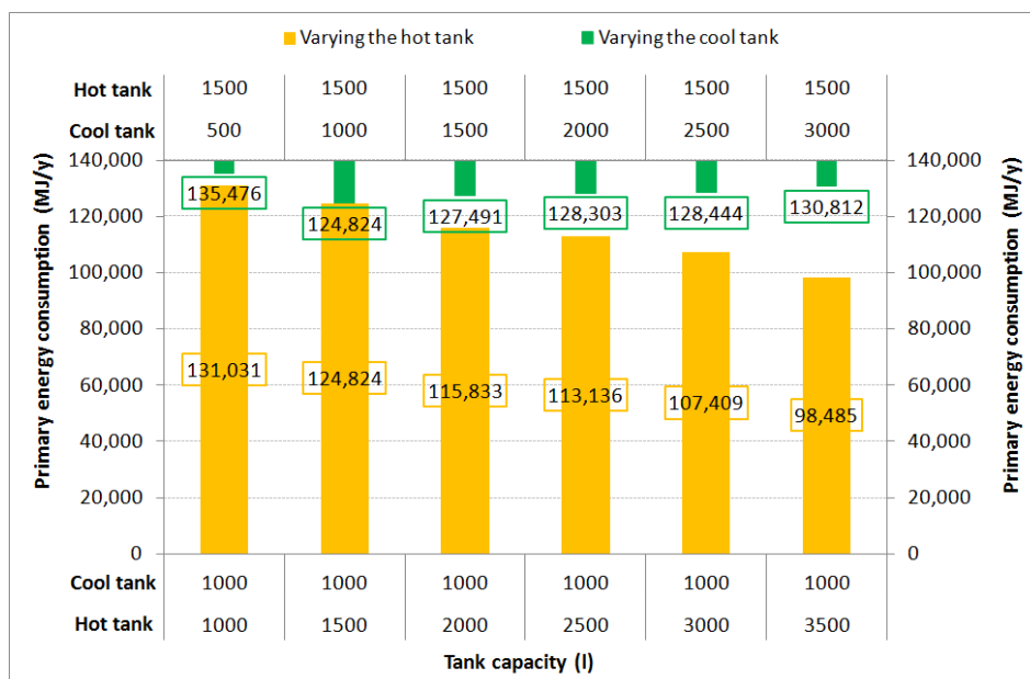
Figura 26 - Simulazioni annuali: consumo totale di energia primaria al variare della capacità del serbatoio di accumulo solare mantenendo costante la dimensione del serbatoio freddo (istogrammi ocra, asse orizzontale inferiore) e consumo totale di energia primaria al variare della capacità del serbatoio di accumulo freddo mantenendo costante la dimensione del serbatoio solare (istogrammi verdi, asse orizzontale superiore)
