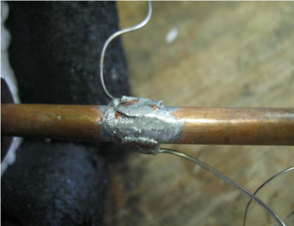
Figura 39-particolare delle termocoppie brasate sulla sezione adiabatica
