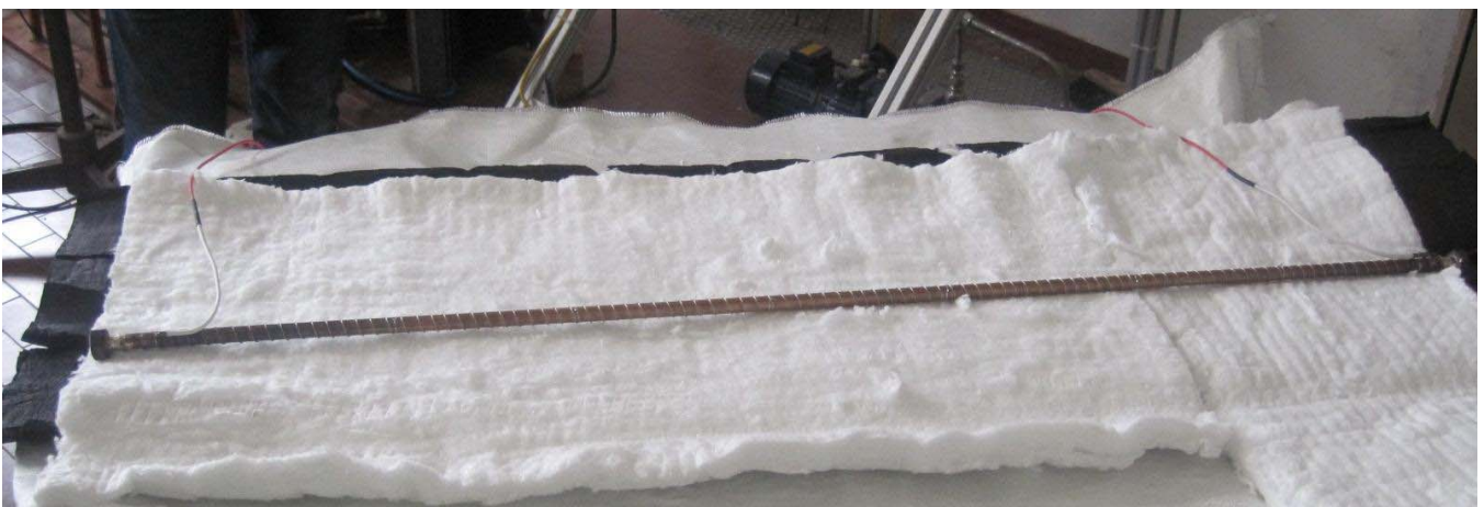
Figura 27-camicia e resistenza a filo avvolta intorno ad essa
