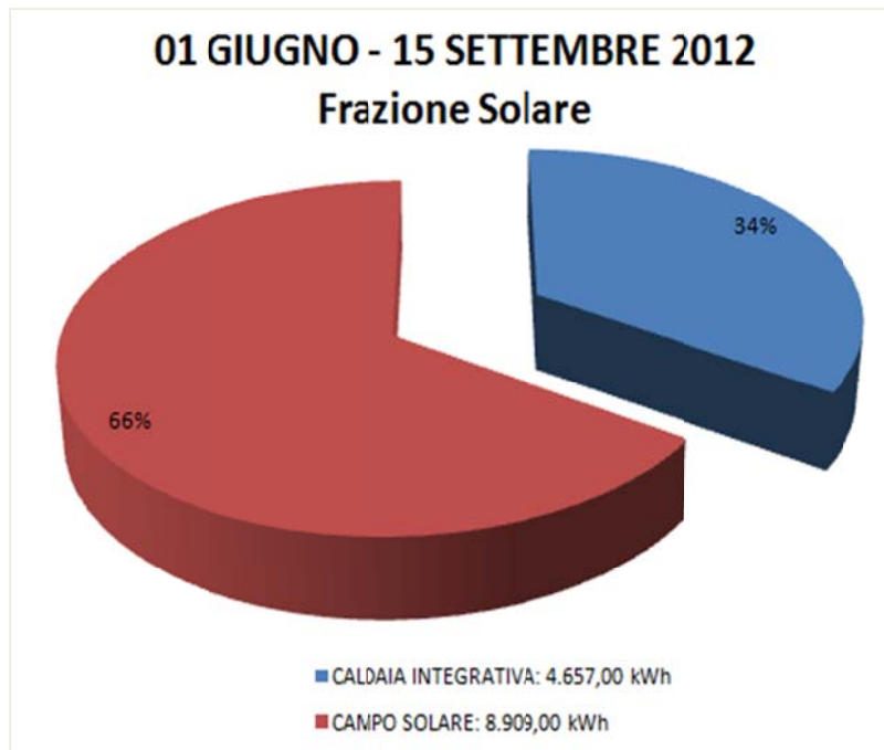
Figura 77. Frazione solare impianto di solar cooling C.R. ENEA di Casaccia per il periodo estivo 2012
