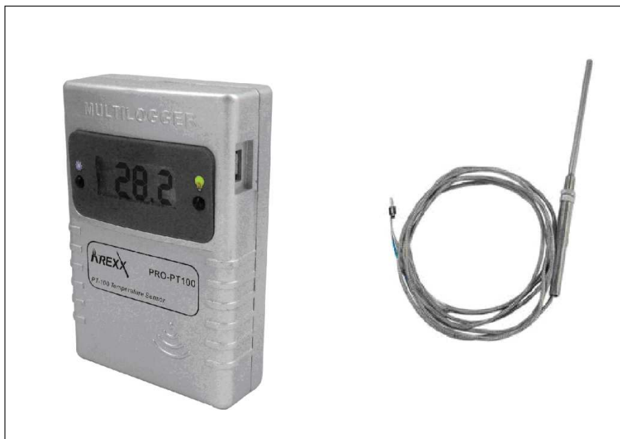
Figura 4 - Misuratori di temperatura (Tipo AREXX mod. PRO-PT100)
