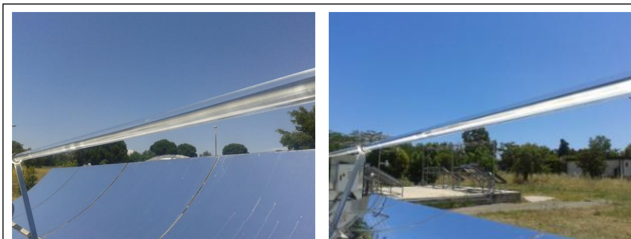
Figura 29 - Foto del collettore parabolico lineare in fase di sperimentazione
