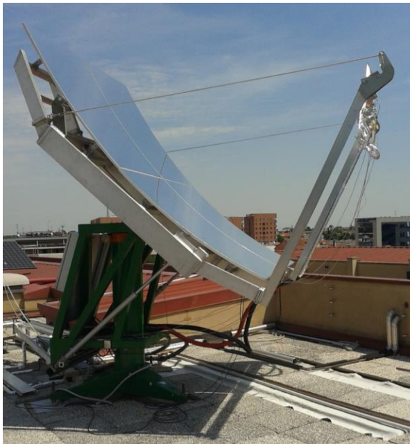
Figura 2.5. Prototipo di concentratore solare installato presso il Dipartimento di Ingegneria Industriale dell'Università degli Studi di Padova.
