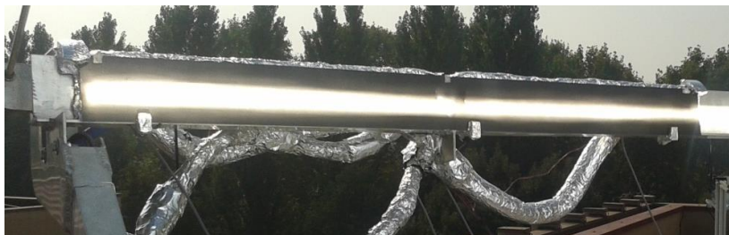
Figura 2.6. Prototipo di ricevitore termico a minicanali, installato sul concentratore, durante una prova.
