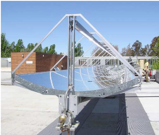
Figura 2.5. Coventry [17]: prototipo di concentratore parabolico fotovoltaico-termico con inseguimento su un asse.
