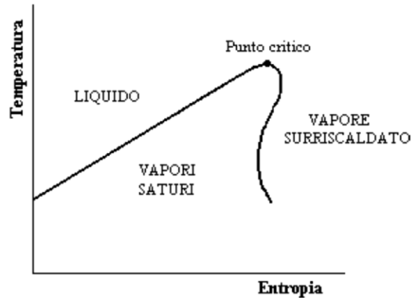
Figura 4. Diagramma T-s di un fluido secco
