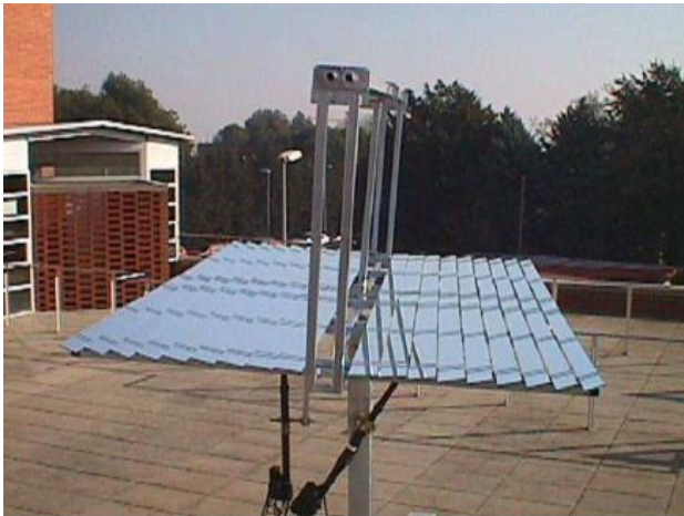
Figura 2.8. Rosell et al. [22]: prototipo di concentratore fotovoltaico-termico con riflettori lineari di Fresnel.
