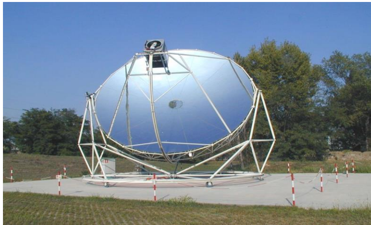
Figura 7. Impianto sperimentale Dish/Stirling EuroDish da 10 kWe.
