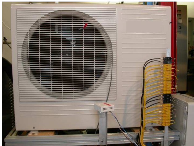
Figura 3 – Pompa di calore commerciale a CO 2 .
