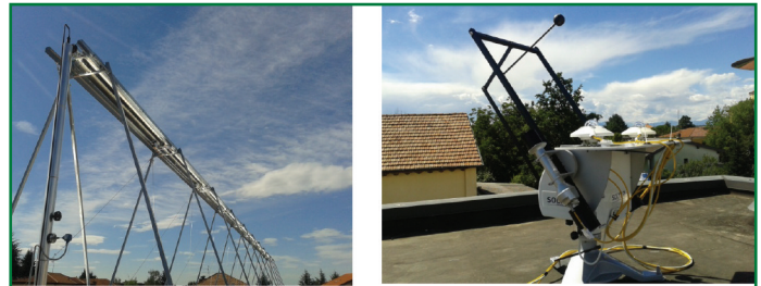
installazione su cui sono state eseguite le sperimentazioni in campo e relativo dettaglio dell'apparecchiatura utilizzata per il monitoraggio della radiazione solare
