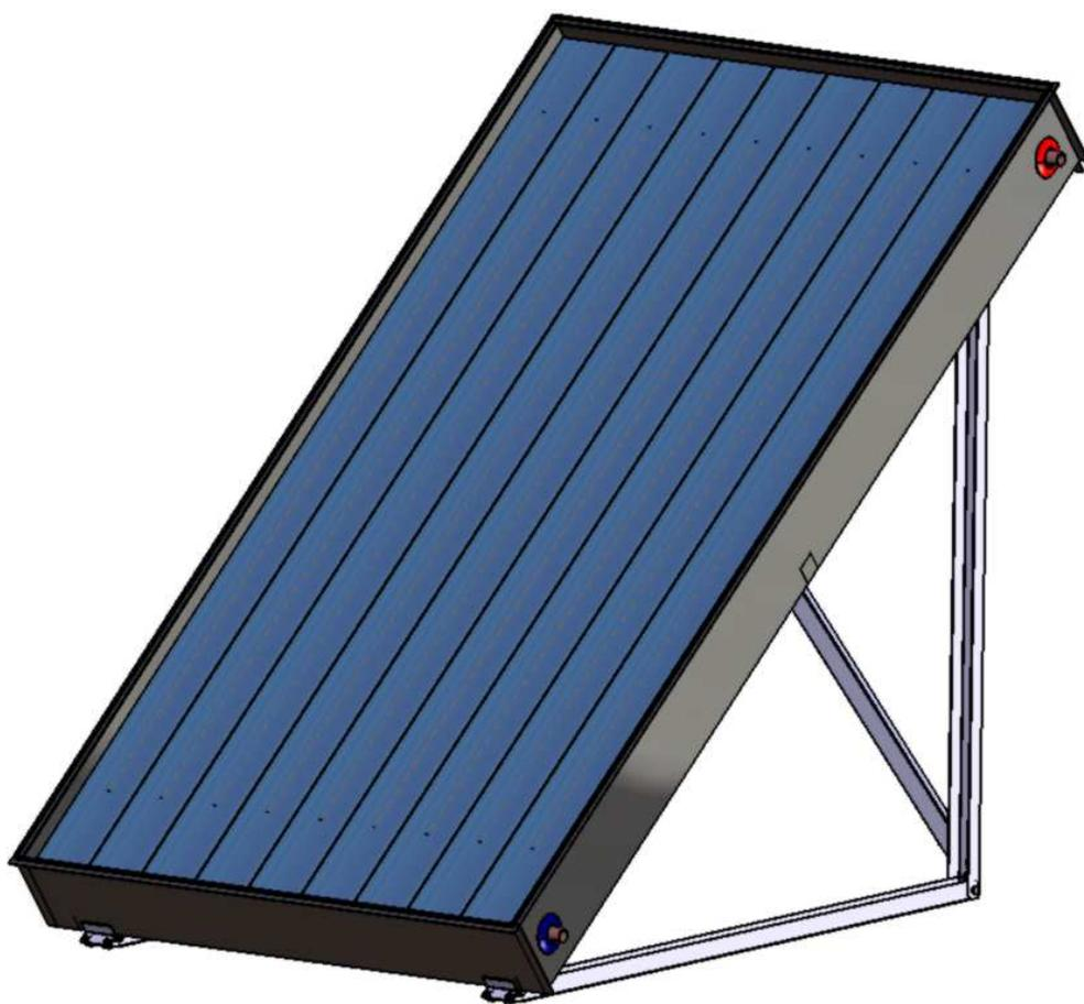
Fig. 12 – Disegno del risultato finale assemblamento nuovo collettore solare.
