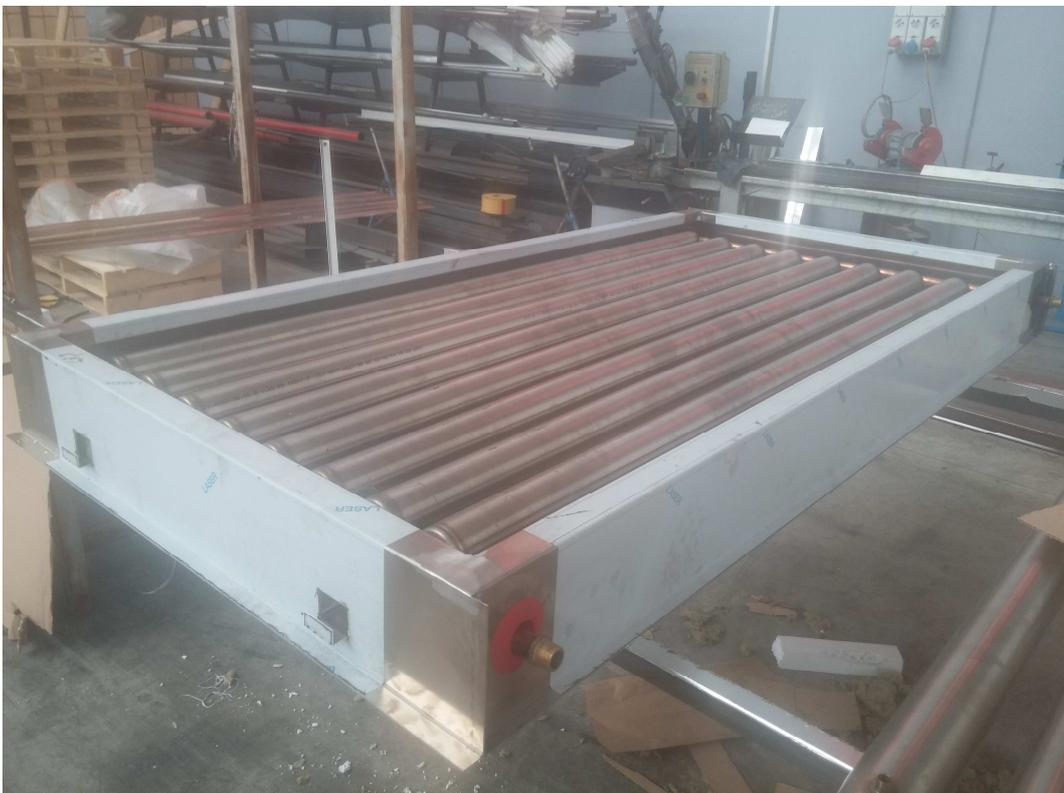
Fig. 31 – Pannello solare assemblato (lato posteriore).
