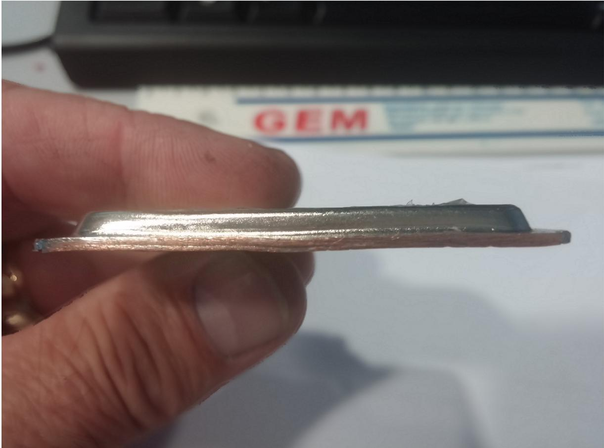
Fig. 15 – Foto di una delle vapor chamber.
