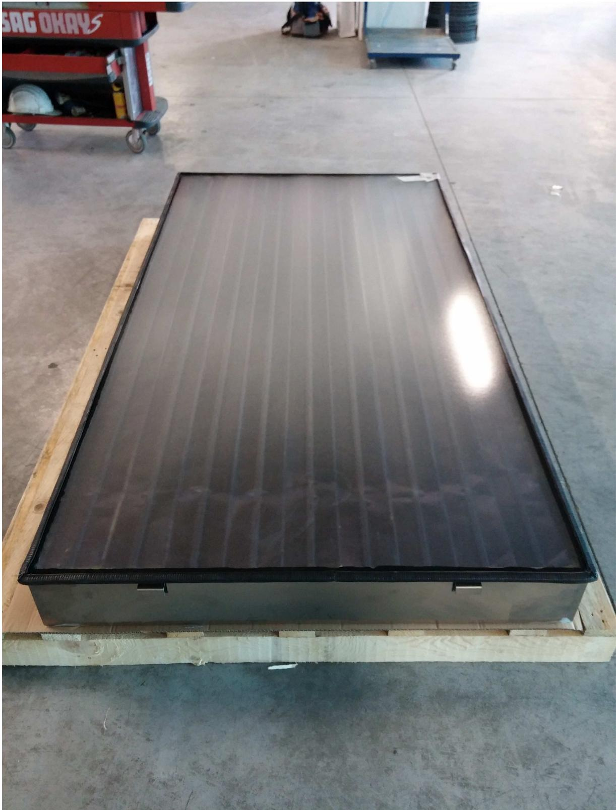
Fig. 34 – Pannello solare assemblato (lato anteriore)..
