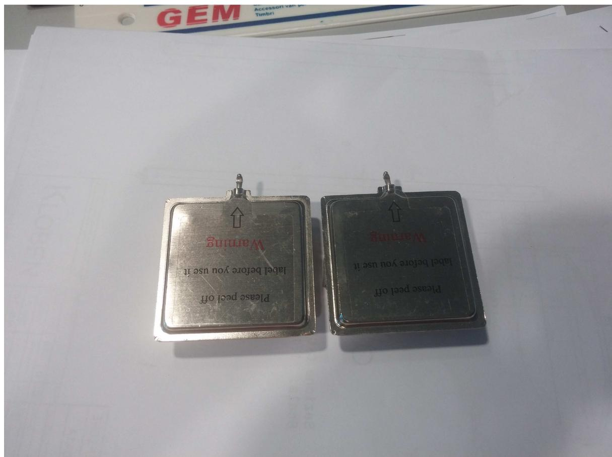
Fig. 14 – Foto delle vapor chamber.
