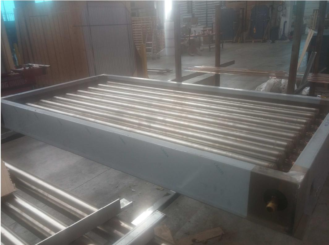
Fig. 30 – Pannello solare assemblato (lato posteriore).
