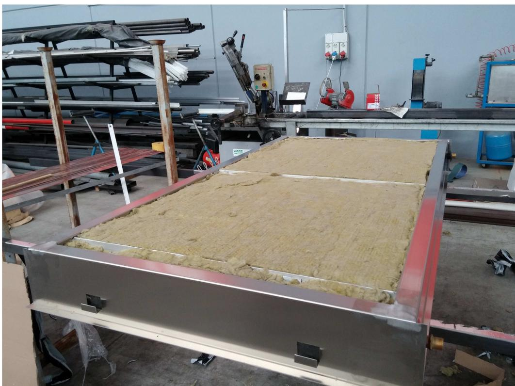
Fig. 32 – Pannello solare coibentato (lato posteriore).
