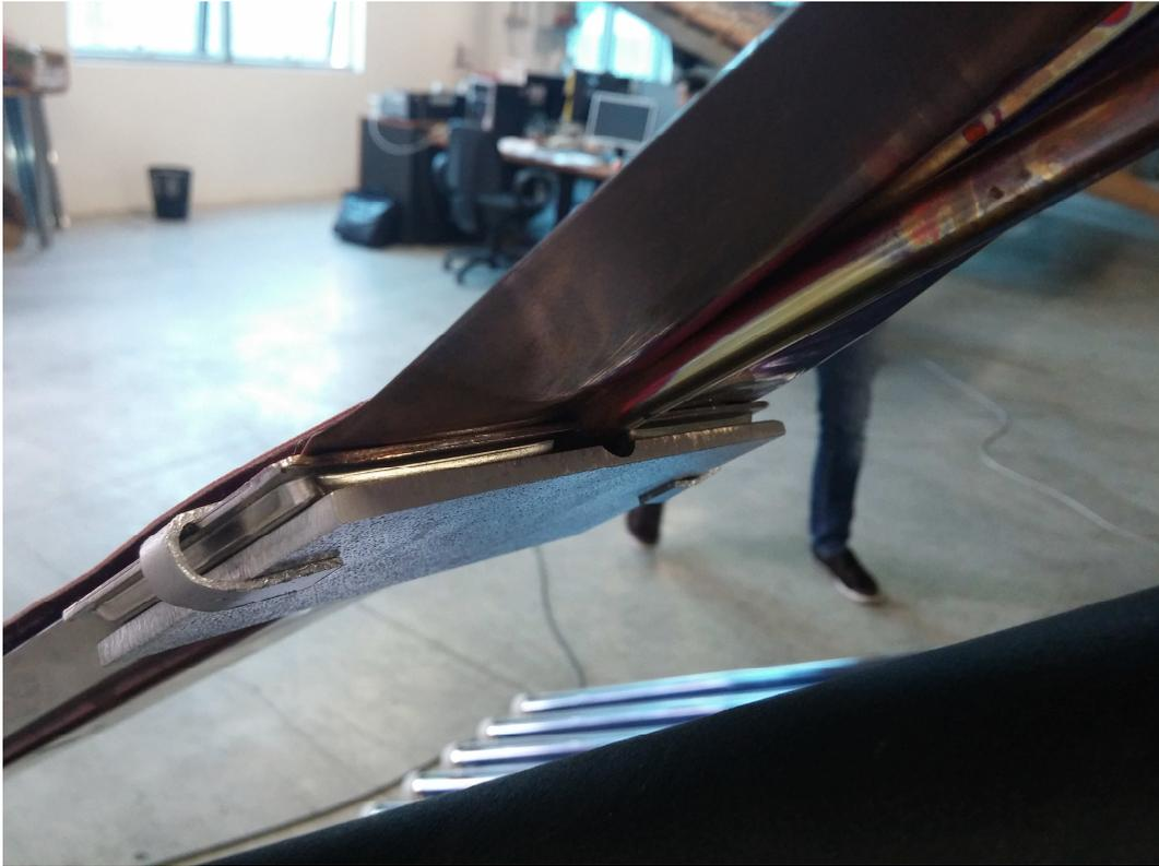
Fig. 68 – Veduta della disposizione della vapor chamber
