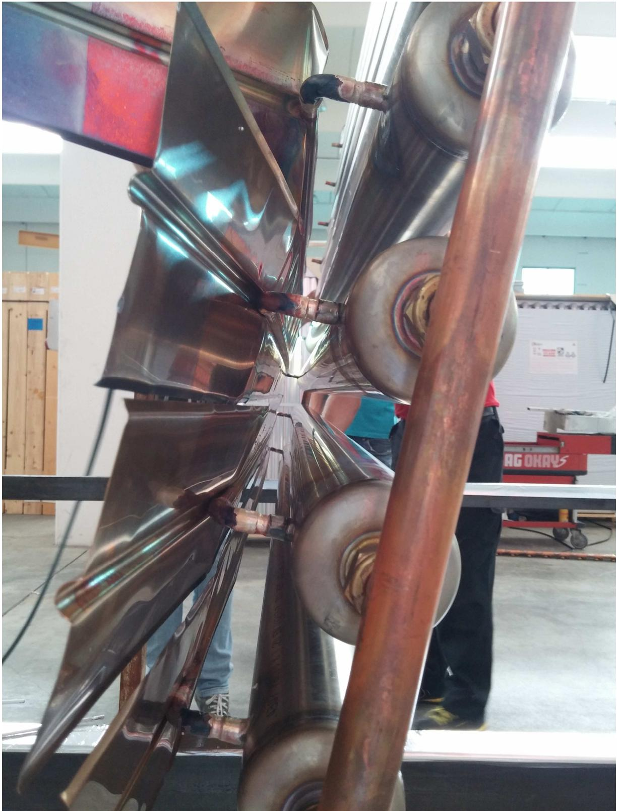
Fig. 27 – Particolare dell'accoppiamento fra piastra assorbitrice e tubo ricevitore.
