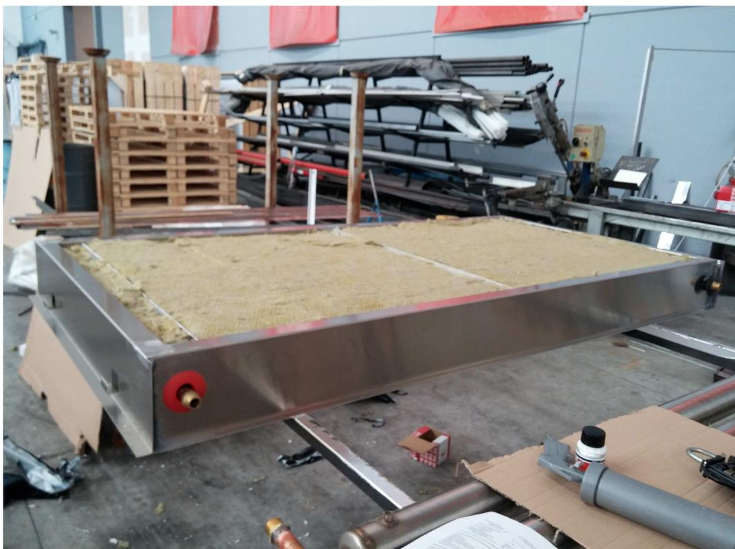
Fig. 33 – Pannello solare coibentato (lato posteriore).
