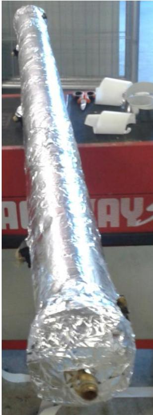
Figura 5.16 – Isolamento del serbatoio.
