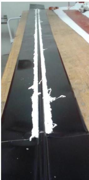
**Figura 5.13 – Applicazione della pasta conduttiva.**
