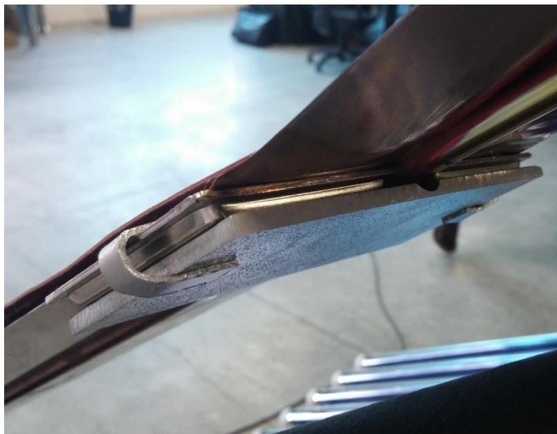
Figura 5.18 – Applicazione della *vapor chamber* prima dell'applicazione dell'isolamento.
