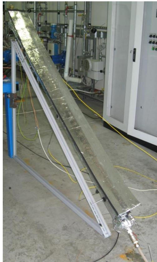
Figura 5.17 – Modulo del collettore durante la prova sperimentale (senza *vapor chamber* e con isolamento sopra la piastra).
