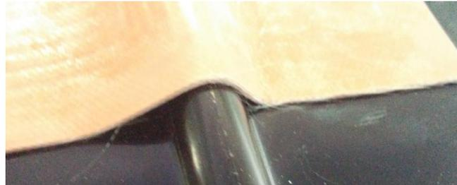
**Figura 5.14 – Spazi d'aria che si creano tra piastra e resistenza elettrica a striscia.**
