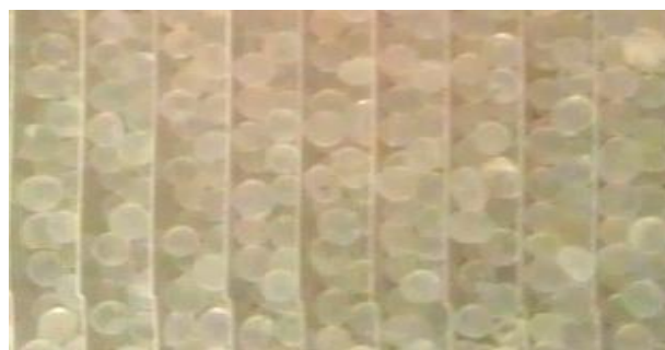
Figura 9: Foto del Silice gel posto tra le alette della batteria
