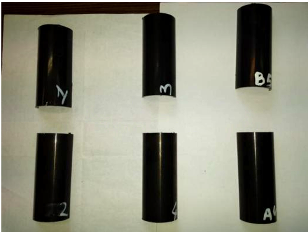
Figura 32: Foto dei campioni di tubo ricevitore da sottoporre ad analisi delle caratteristiche ottiche
