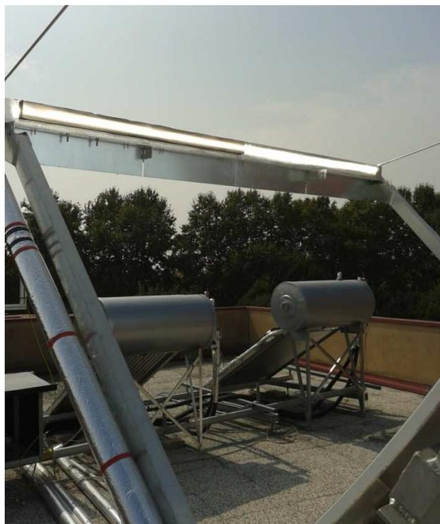
**Figura 2 - Ricevitore a minicanali per la produzione di calore a media temperatura. In alto: dettaglio della parte frontale. In basso: ricevitore installato sul concentratore durante un test presso il Laboratorio di Conversione dell'Energia Solare dell'Università di Padova.**
