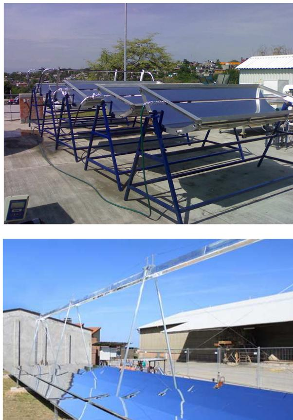
**Figura 1 - Sistemi solari a concentrazione a fuoco lineare per applicazioni termiche a media temperatura. In alto: concentratore a specchi parabolici [1]. In basso: concentratore lineare Fresnel [2]**
