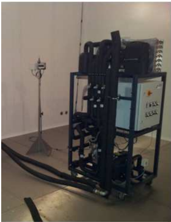
Figura 16. I due prototipi installati in camera climatica (a destra la macchina a R290)
