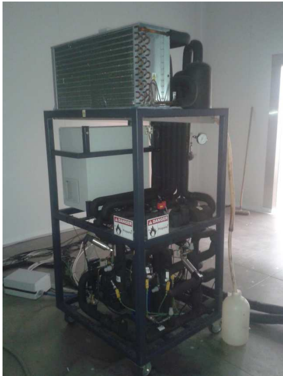
Figura 16. I due prototipi installati in camera climatica (a destra la macchina a R290)
