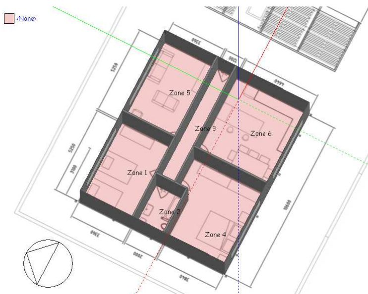
Figura 77. Pianta suddivisione in zone dell'edificio.
