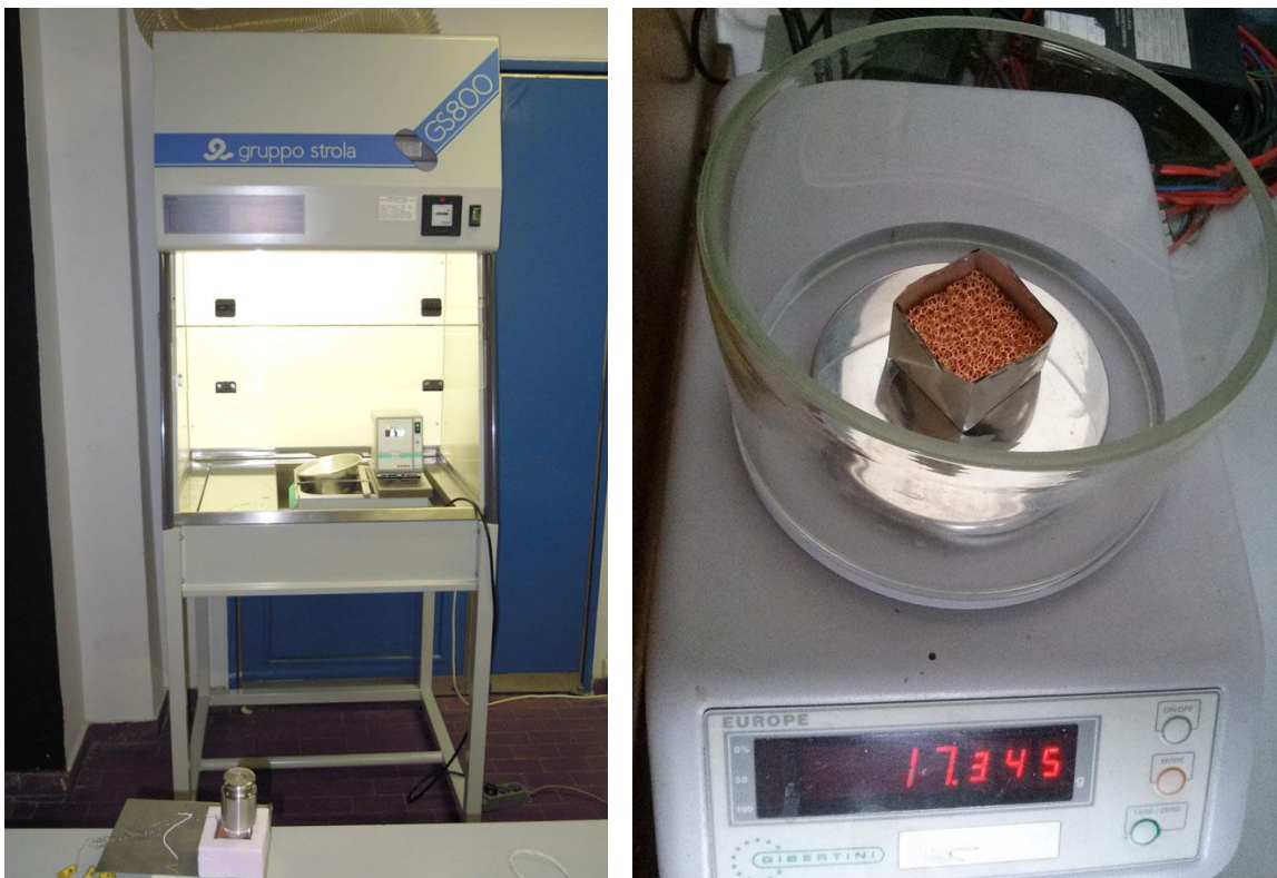
Figura 6 – a) Cappa con all’interno il bagno termostato; b) blocchetto di schiuma nel contenitore in “coffee bag”, sulla bilancia
