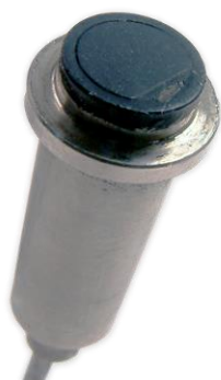
Figura 24: Sensore di flusso termico VateLL HFM-7E/L con sonda RTD per la misura della temperatura superficiale
