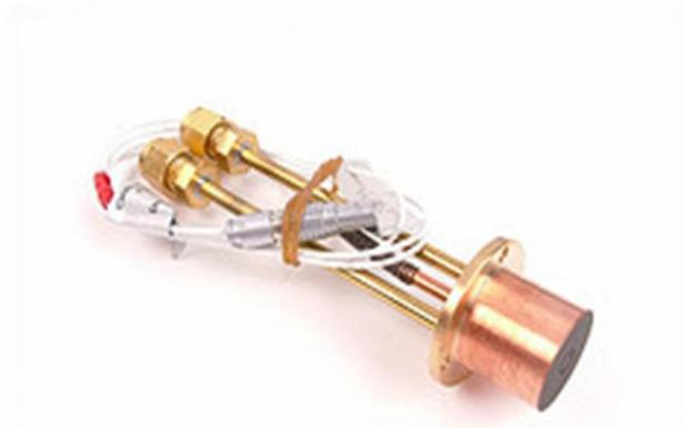
**Figura 31 - Sensore di flusso termico Vatel HFM-7E/L con corpo di raffreddamento in rame (Vatell Corporation 2015).**
