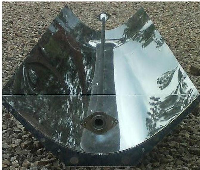
**Figura 3 – Collettore lineare parabolico (Solar Mountain Energy).**
