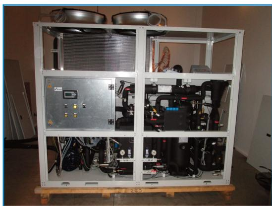
Prototipo PDC ad R744 reversibile (caldo/freddo) dotato di un eiettore: potenzialità 30 kW
