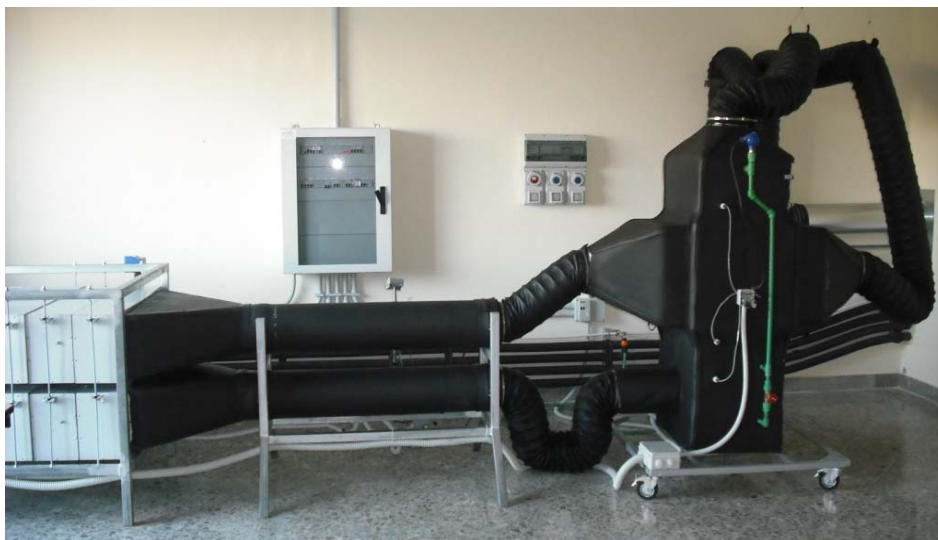
Figura 23: Foto del set up sperimentale per il test di componenti aeraulici
