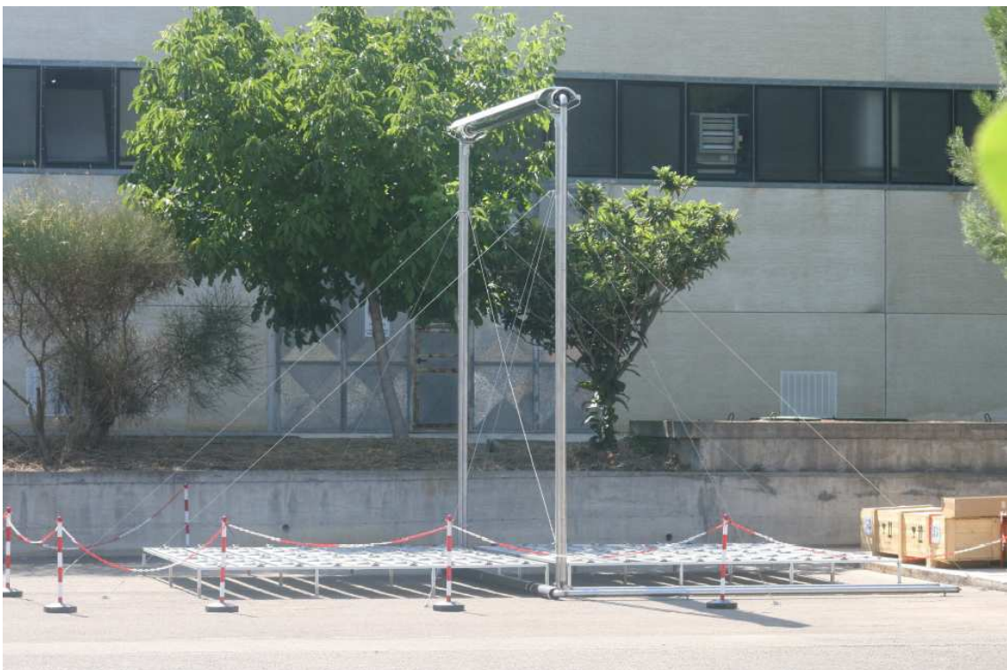
Fig. 4 – Concentratore lineare a specchi di Fresnel (DWA)
