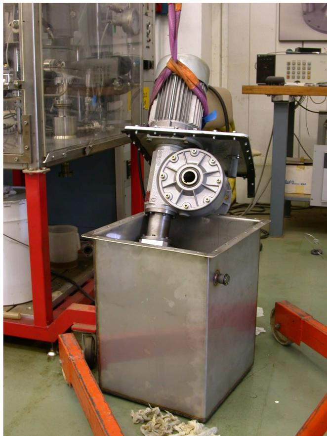
Fig. 12: Pompa della soluzione ricca, fase di montaggio
