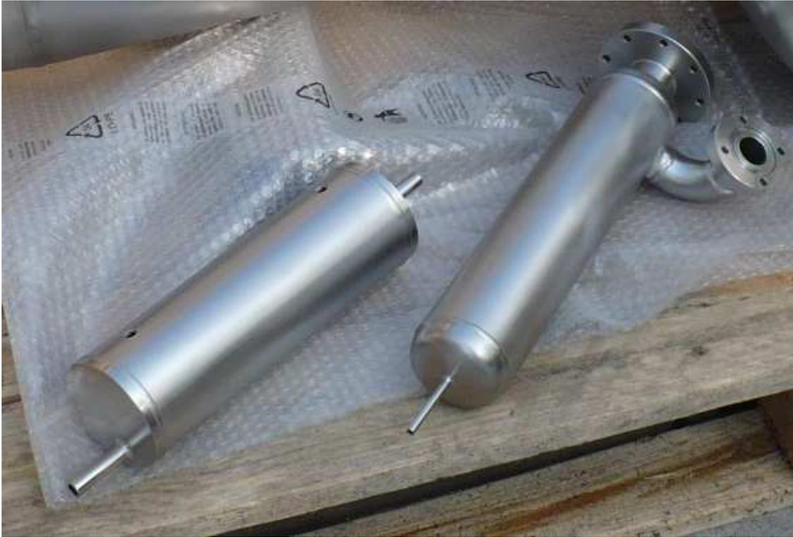
Fig. 14: Accumulo Ammoniaca e Filtro Pompa
