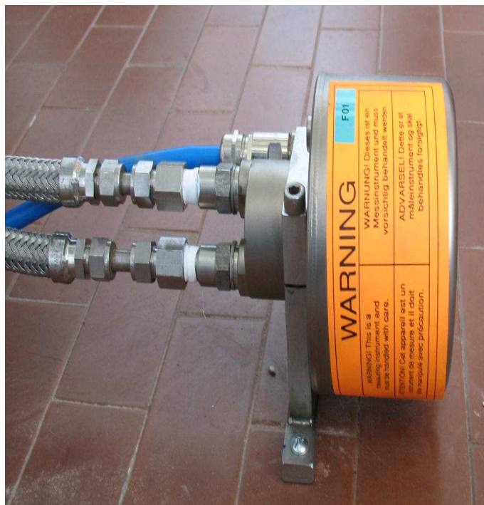
Fig. 17 - Misuratore di portata
