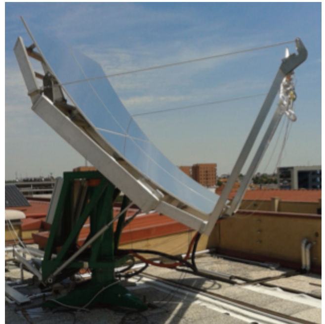
Prototipo di concentratore solare a specchi parabolici con inseguimento su due assi con fuoco lineare
