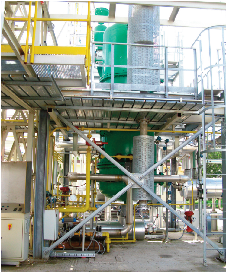
Piattaforma sperimentale ZECOMIX per lo sviluppo dell'omonimo ciclo di cattura della CO 2
