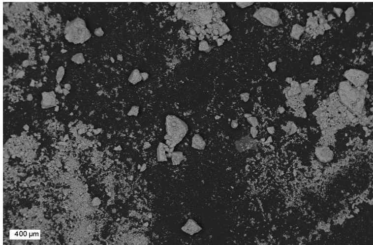
Figura 3- G1-85: gli elementi presenti sono Ni, Al, O, Zr; la granulometria delle particelle è eterogenea, da decine di nm a centinaia di \mu\text{m} ; Film del catalizzatore omogeneo con spot bianchi relativi a Zr.
