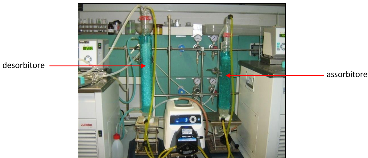
Figura 9- Sistema a ciclo chiuso per l' assorbimento e il desorbimento di CO 2 con le soluzioni non acquose delle ammine. La temperatura nei due cilindri è controllata con circolazione di glicol etilenico termostattizzato.
