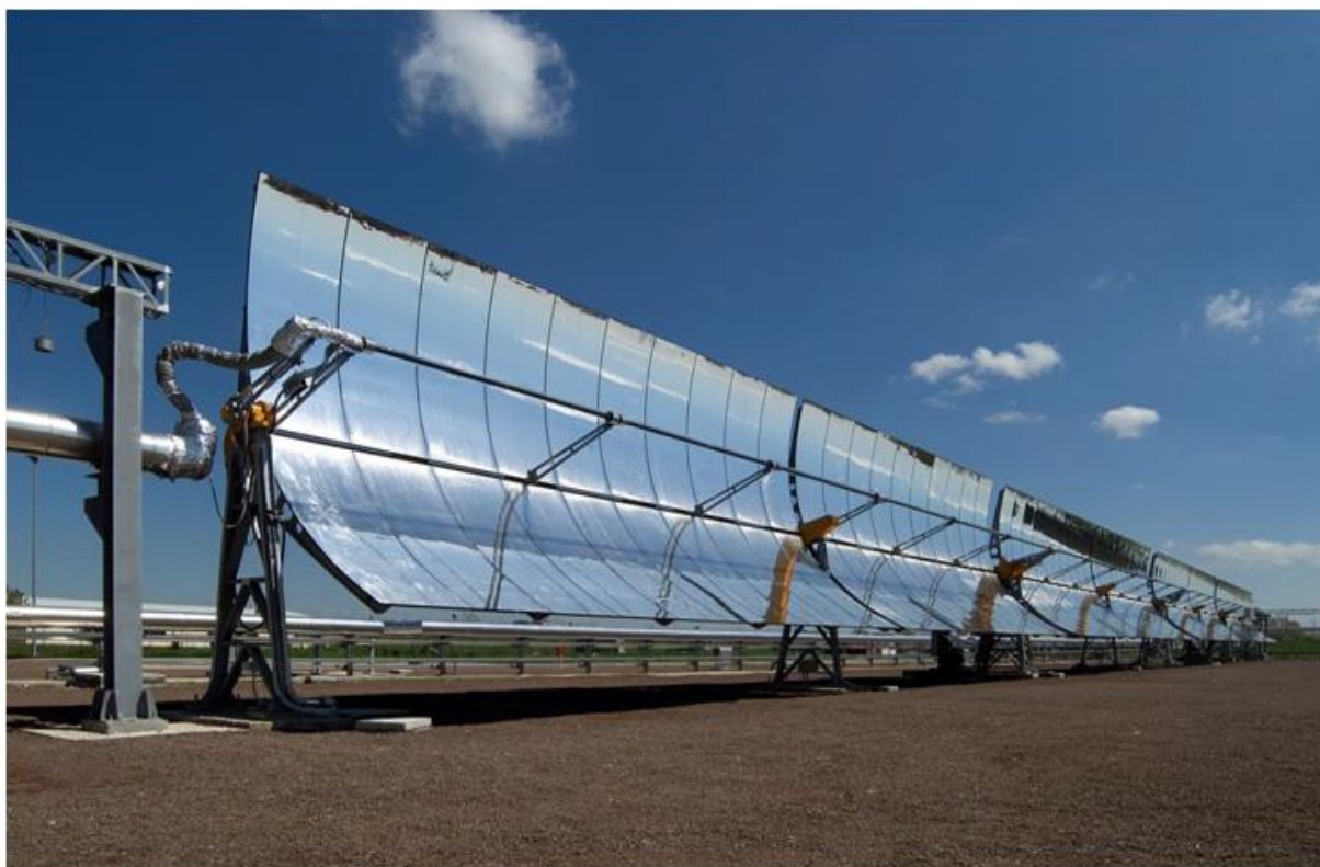
Figura 3.3 Rappresentazione di un tipico collettore parabolico lineare.
