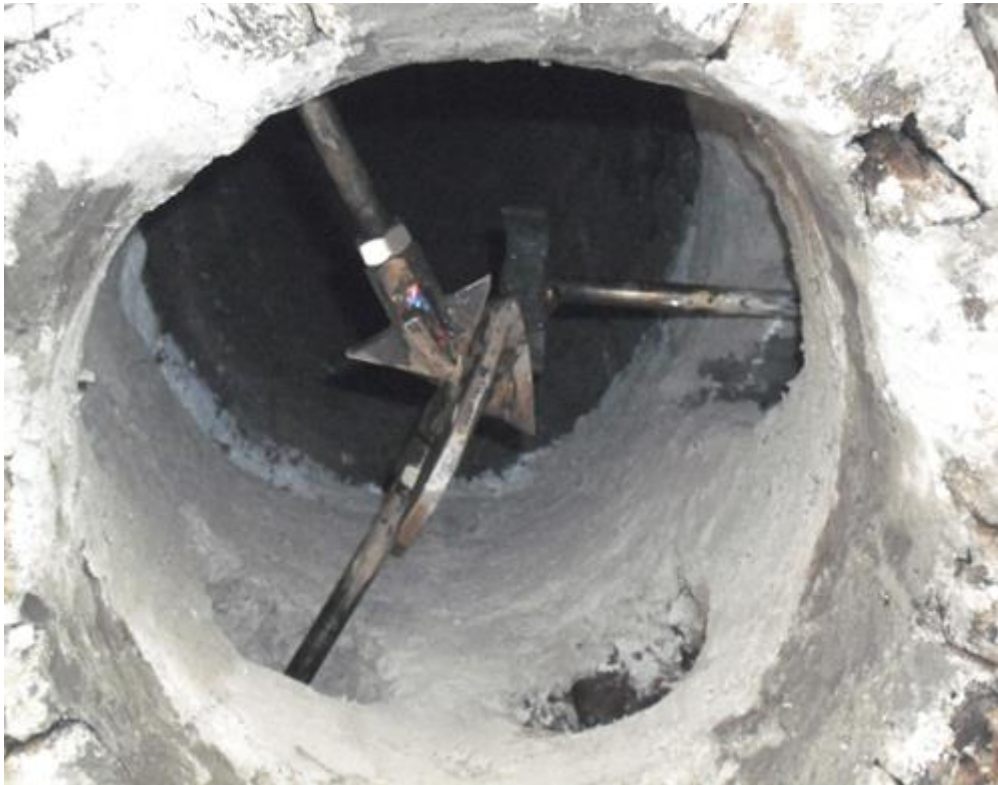
Figura 2.7 - agitatori del letto di gassificazione
