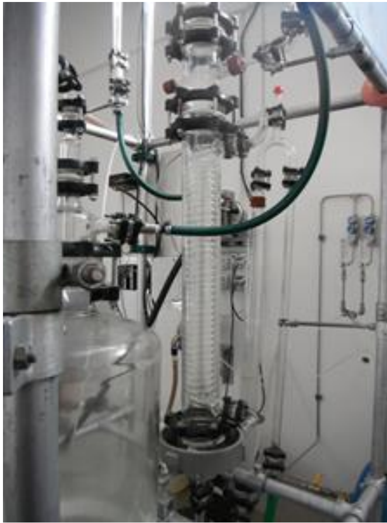
Figura 15-12. Scambiatore di calore.
