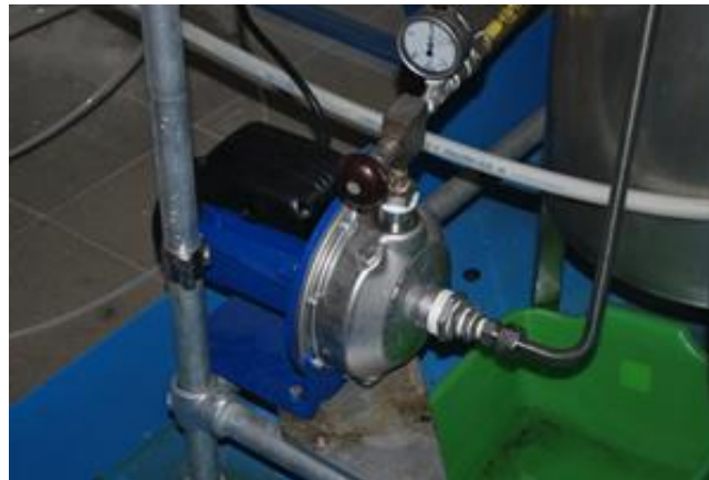
Figura 15-9 Sistema di rilancio del solvente in colonna.
