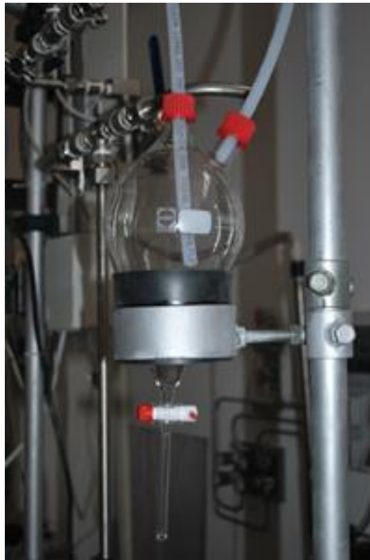
Figura 15-15. Sistema di separazione e scarico della condensa.
