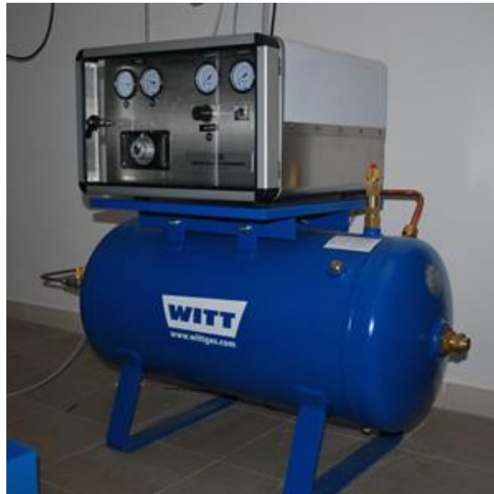
Figura 15-4 Sistema di miscelazione dei gas con polmone di accumulo.
