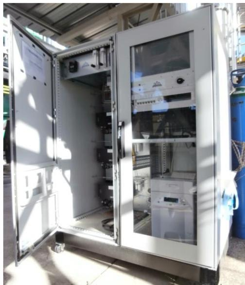
**Figura 10 - Unità di analisi gas.**
