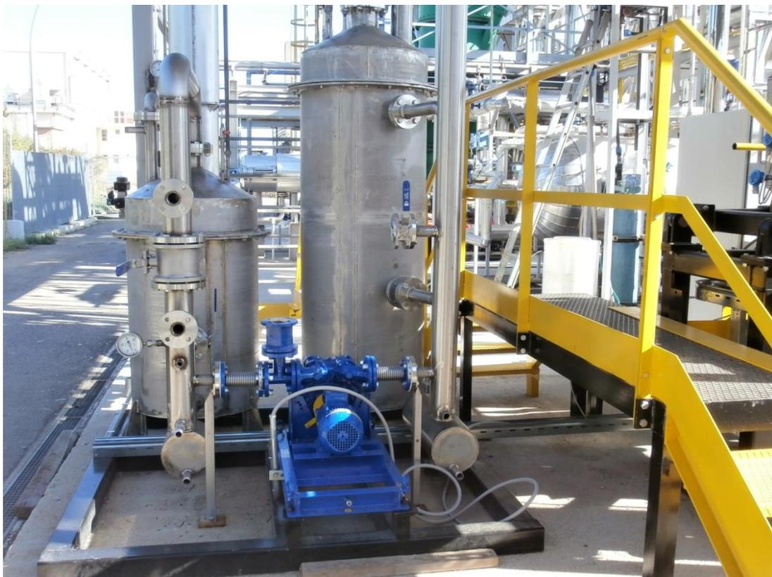
**Figura 6 – Soffiante e sistema di raffreddamento – alloggiamento su skid**
