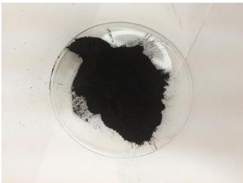
**Figura 2. Campione di carbone russo sottoposto a macinazione nel mulino a croce**
