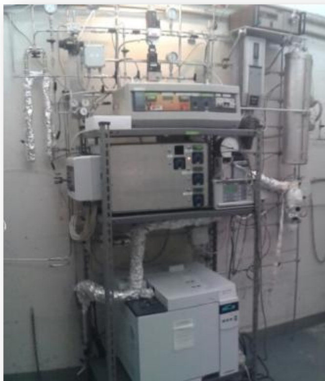
Figura 1.1: Impianto di laboratorio per i test catalitici Fischer-Tropsch.
