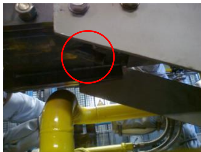
Figura 2-4: Vista inferiore della base del TVC. Il particolare evidenziato è il condotto collegato alla presa di pressione.
