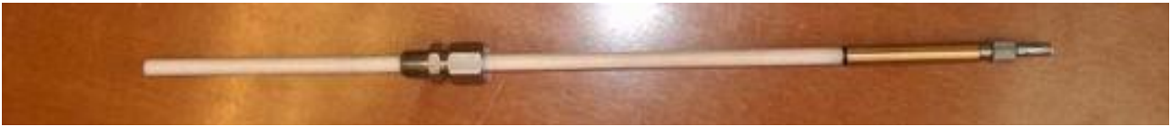
Figura 2-14: Testa ottica con fibra di zaffiro ( \Phi = 2 \text{ mm} ) in un tubo protettivo di allumina ( \Phi \approx 5 \text{ mm} ).
