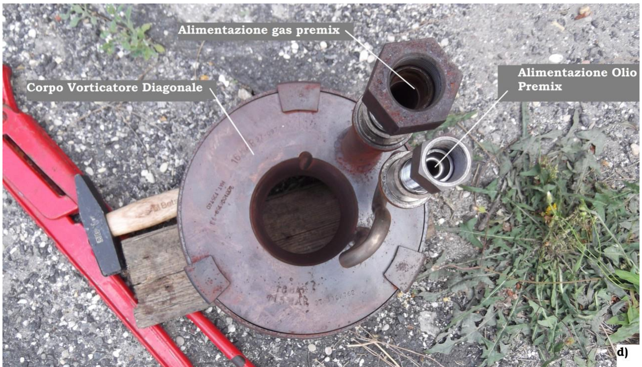
Figura 9. Immagini del bruciatore Siemens-Ansaldo V64.3A nella versione originariamente installata sull'impianto COMET.
