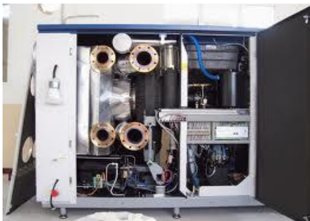
Figura 2. Turbec T100 modificata per la connessione fluidodinamica al vessel. Vista lato flange di connessione.
