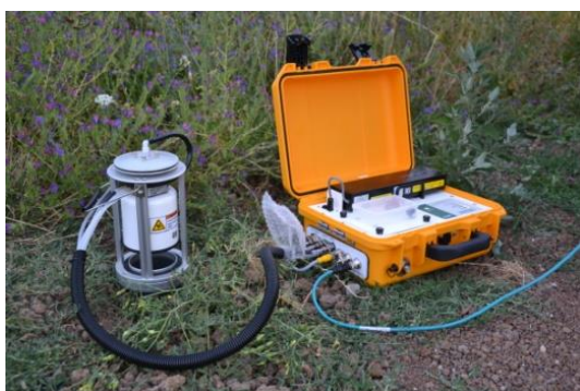
Figura 2 – Strumentazione portatile per la misura della concentrazione e del flusso di CO 2 dal suolo
