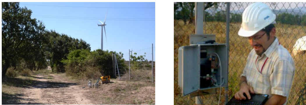
Figura 6– Stazione di monitoraggio in prossimità dei piezometro campionamento acque e gas di suolo
