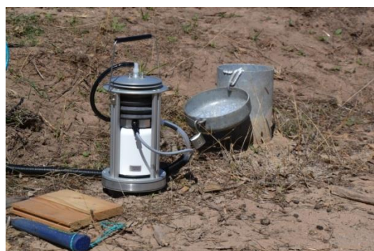
Figura 2 – Strumentazione portatile per la misura della concentrazione e del flusso di CO 2 dal suolo
