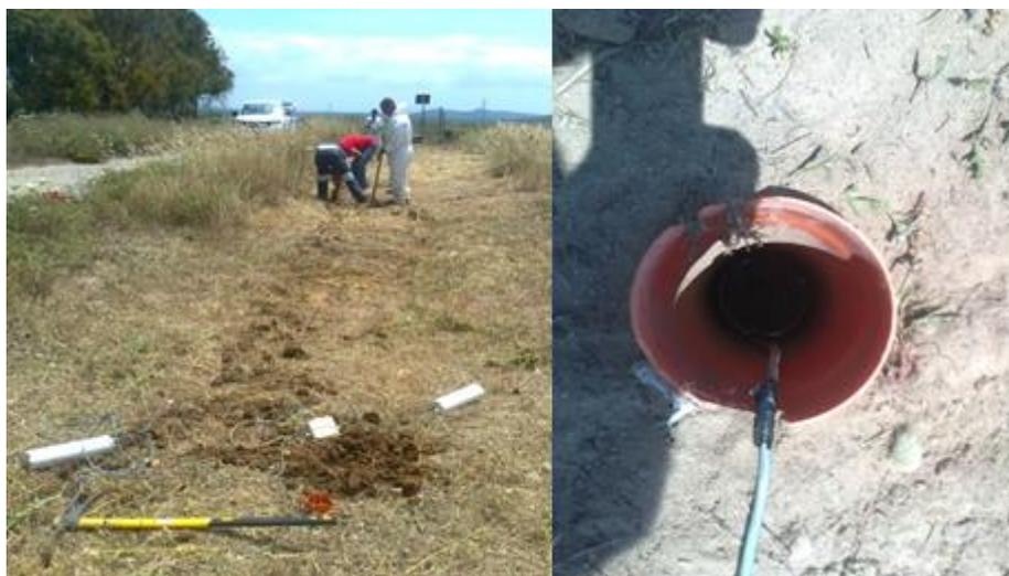
**Figura 2. Stazioni di monitoraggio con piezometri nel Sulcis.**
