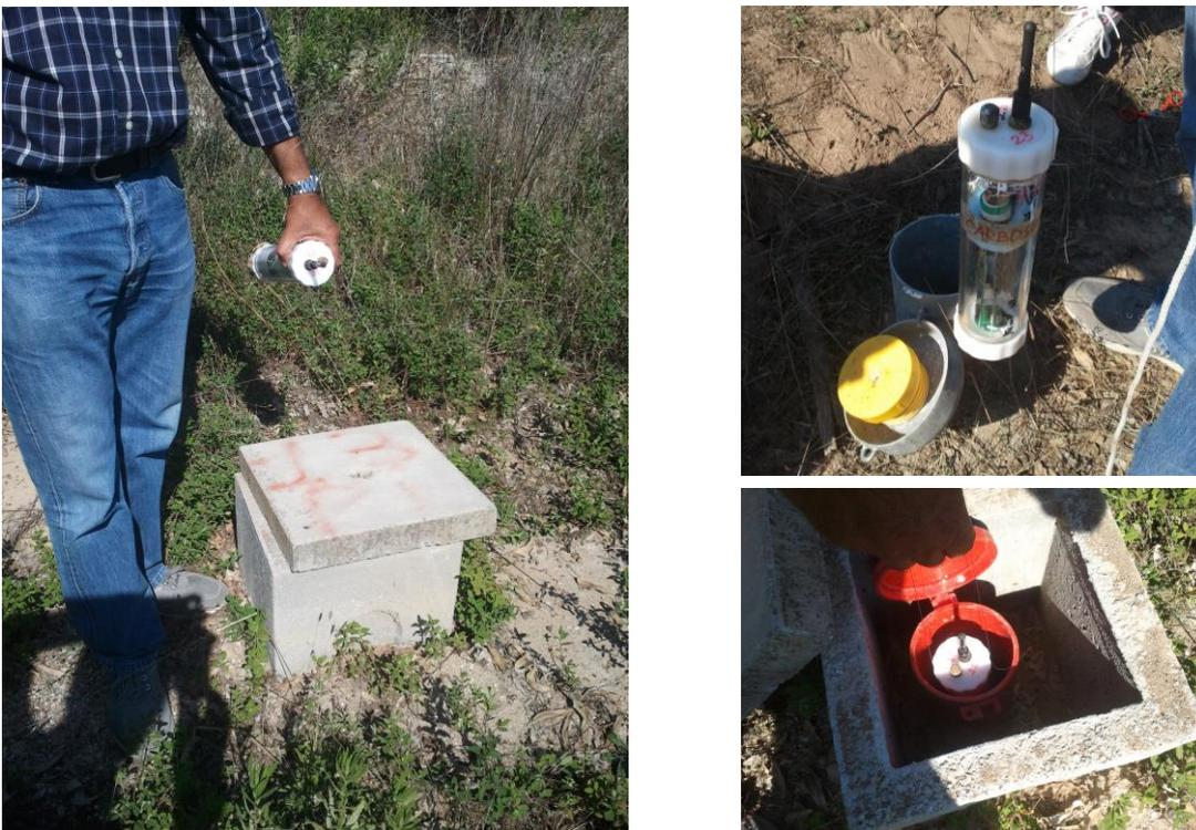
Figura 9. Posizionamento delle sonde nei piezometri.
