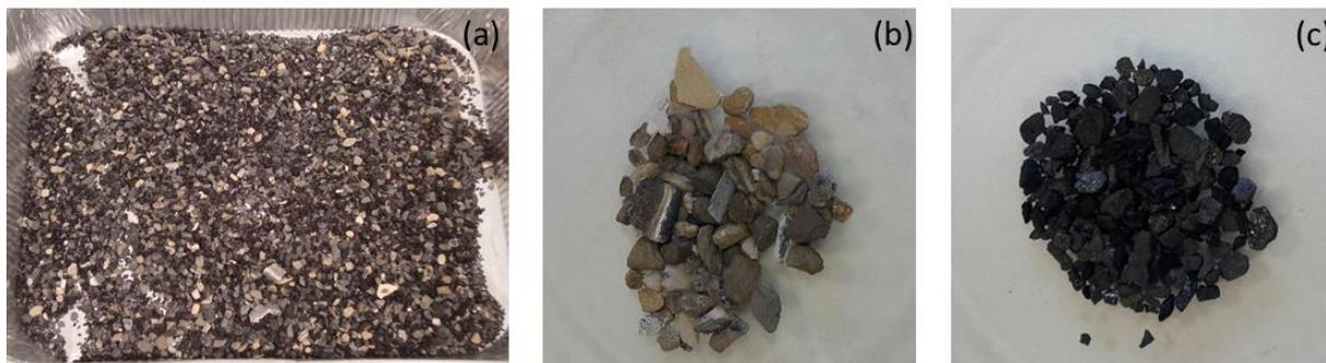
**Figura 13. Immagini della (a) Classe E, (b) frazione “bianca” e (c) frazione “nera” della classe E.**
