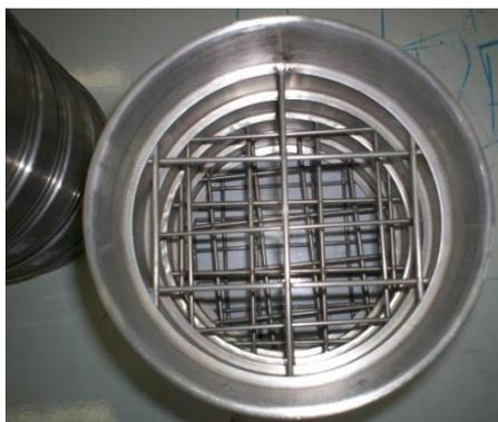
Figura 2. Esempio di setacci utilizzati per l'analisi granulometrica.
