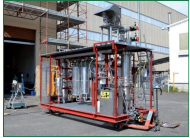
“Pilota” presso la sede di Sotacarbo, test preliminari e sperimentazioni per ottimizzare il processo mediante l'impiego di solventi liquidi a base di ammine, in condizioni che simulano, grazie all'utilizzo di apposite miscele di gas, quelle di post-combustione, tipiche della cattura operata sui fumi provenienti dalla combustione di carbone in caldaie.
